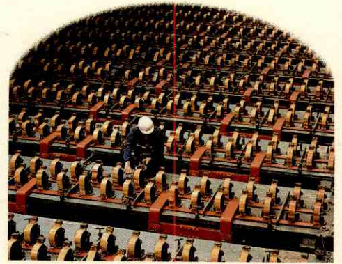
يُحضَّر هيدروكسيد الصوديوم بإمرار الكهرباء عبر السائل الملحي في هذه الخلايا الإلكتروليتية.
